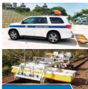
3Dレーダ探査
