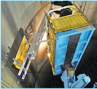
覆工背面レーダ探査(3D・パルスレーダ)
