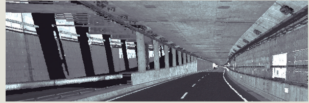
壁面撮像用ラインカメラ ・ 8192画素(8K相当)ラインカメラを14台配置 平坦性センサ ・ 3台の平坦性レーザーセンサを配置 高精度・高密度レーザー路面撮像用ラインカメラ ・ 100万点/秒の高精度レーザーを2台配置 ・ 8192画素(8K相当)ラインカメラを2台配置
