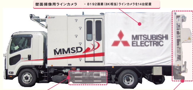
壁面撮像用ラインカメラ ・ 8192画素(8K相当)ラインカメラを14台配置 平坦性センサ ・ 3台の平坦性レーザーセンサを配置 高精度・高密度レーザー路面撮像用ラインカメラ ・ 100万点/秒の高精度レーザーを2台配置 ・ 8192画素(8K相当)ラインカメラを2台配置
