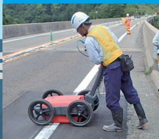
橋梁床版調査
