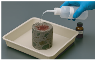
塗布した試薬を精製水で洗い流す
