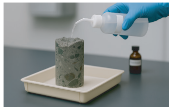
試料を精製水で洗浄
